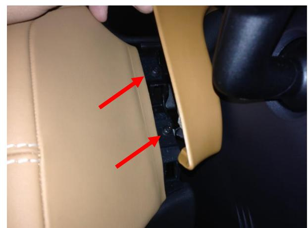
Вывернуть саморезы и снять панель.
