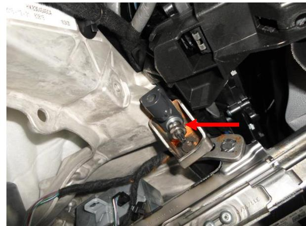
Срывной гайкой притянуть верхнее крепление замка.
